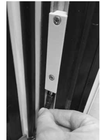
4. Stecker an Nachladebuchse anstecken, Fenster schließen und Ladegerät an Steckdose anschließen
