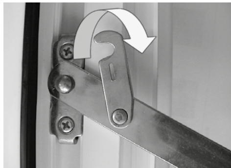
2. Justierung horizontal Putzschere entriegeln und aushängen. ACHTUNG: Der Flügel ist nun ungesichert und muss durch eine zweite Person gesichert werden! Der Flügel darf max. 90° gekippt werden!
